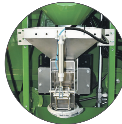
HALDRUP HD-FLOW in Kombination mit NIRS-Gerät und Liebherr Feuchtigkeitssensor
